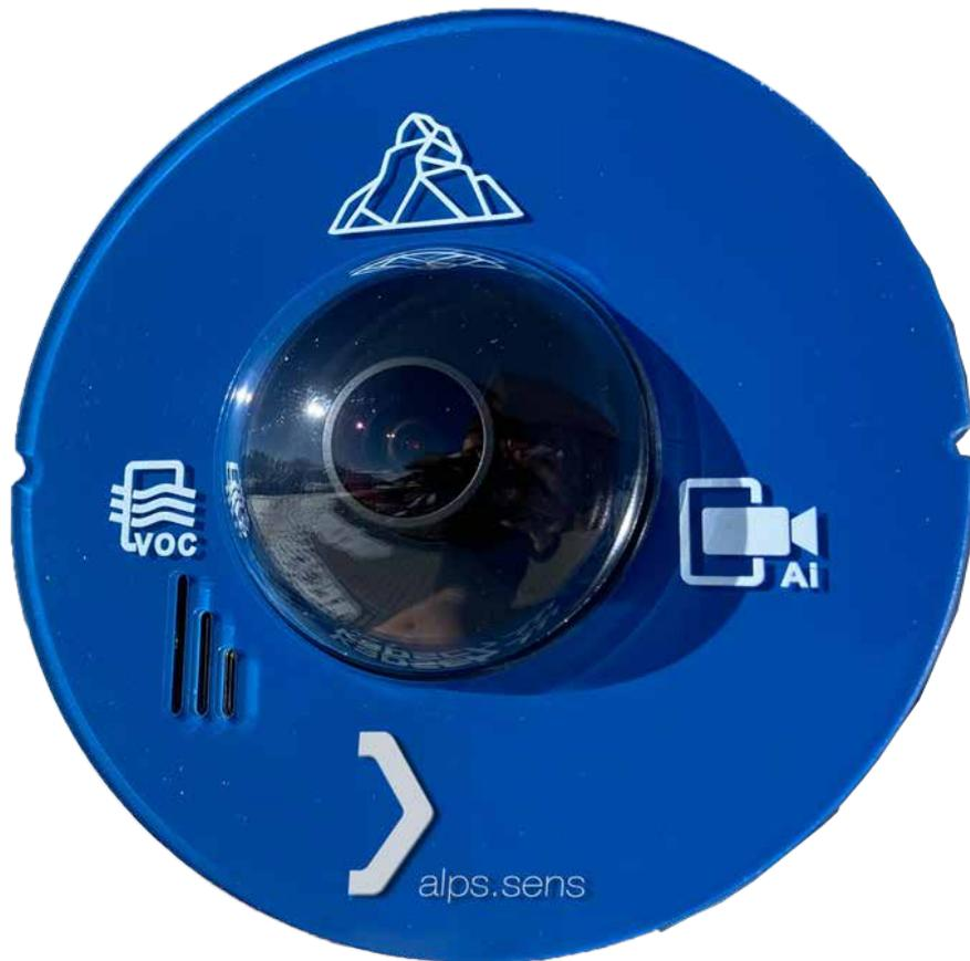
**IGS-COM** ermöglicht eine Vielzahl an Funktionen für automatisiertes Fahren. So erkennt das System zum Beispiel, ob und wie viele Personen in der Kabine sind. Über eine intelligente Objekterkennung werden Personen von Gegenständen differenziert.
